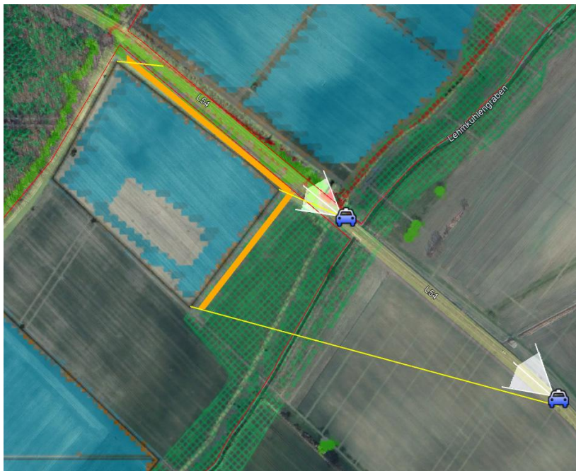
Abbildung 15: Streckenabschnitt auf der L54 mit Reflexionen im relevanten Sichtfeld der Verkehrsteilnehmer, auftretende Immissionswinkel in weiß, relevantes Sichtfeld in weiß, empfohlene Sichtunterbrechung in orange (Quelle: Google Earth, Airbus)
